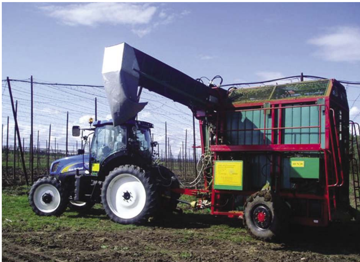
Pojízdná česačka chmele pro nízké konstrukce
