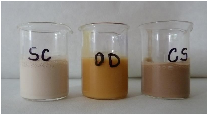
Obrázek 6: Příklady kapalných formulací POR: SC - suspenzní koncentrát, OD - olejová disperze, CS – formulace s řízeným uvolňováním účinné látky.
