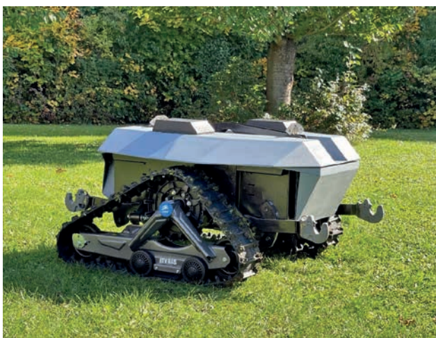
Obrázek 33: Autonomní pozemní platforma pro lehký až středně těžký terén navržena vývojem laboratoří ProLab ve spolupráci s Katedrou zemědělských strojů Technické fakulty ČZU v Praze. Plně elektrický pásový stroj řízený smykem. Osazen dvěma tříbodovými závěsy. Na jedno nabití 20 hod. provozu, dojezd až 100 km, zdroj Kumhála.
