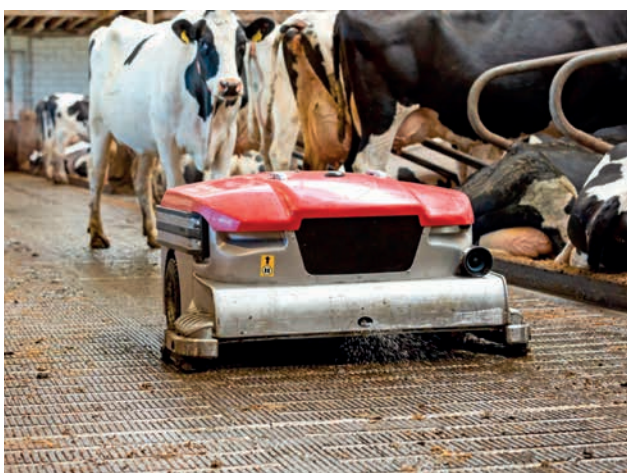
Obrázek 23: Automatický shrnovač/vysavač kejdy Lely Discovery Collector, zdroj agropartner.cz .
