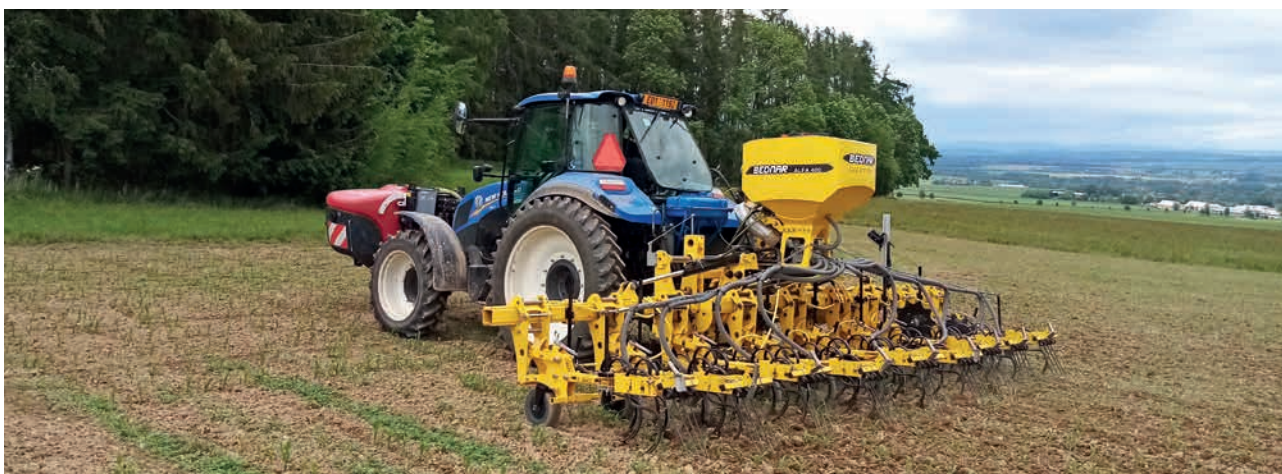
Obrázek 15: Souprava pro mechanickou regulaci plevelů v meziřádku se souběžnou aplikací herbicidu na řádek vyseté plodiny a s cílenou souběžnou aplikací hnojiva pouze k řádku kulturní rostliny, zdroj Brant.
