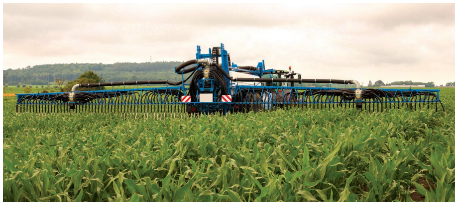
Prototyp aplikátoru ve vzrostlé kukuřici (Foto Mistr)
