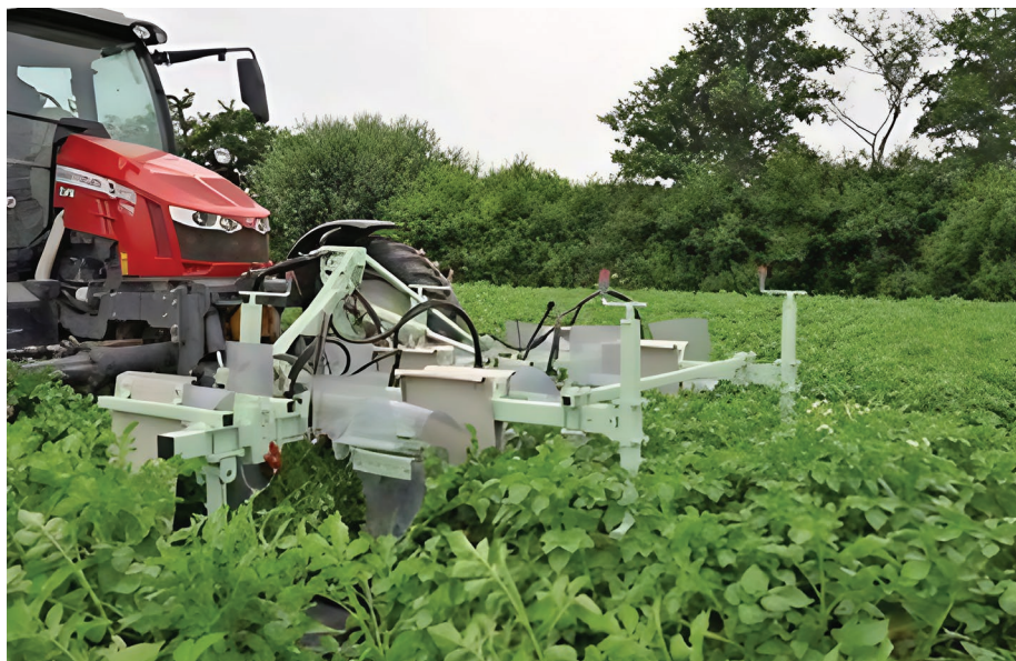
Zařízení na sběr mandelinky a jejich larev umístěné před traktorem (Foto: www.futurefarming.com )
