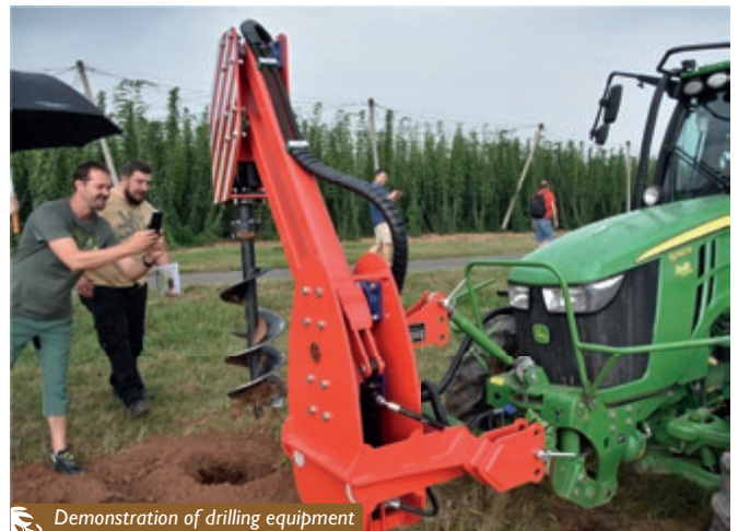
Demonstration of drilling equipment Ukázka zařízení pro vrtání jarek
