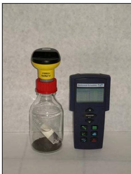
Obrázek 1. Zařízení pro měření půdní respirace OxiTop.
