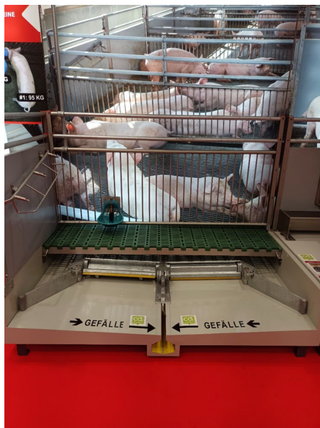
Obrázek 2.57: Detail shnovací podrošové lopaty s drážkou pro efektivní oddělení moči
