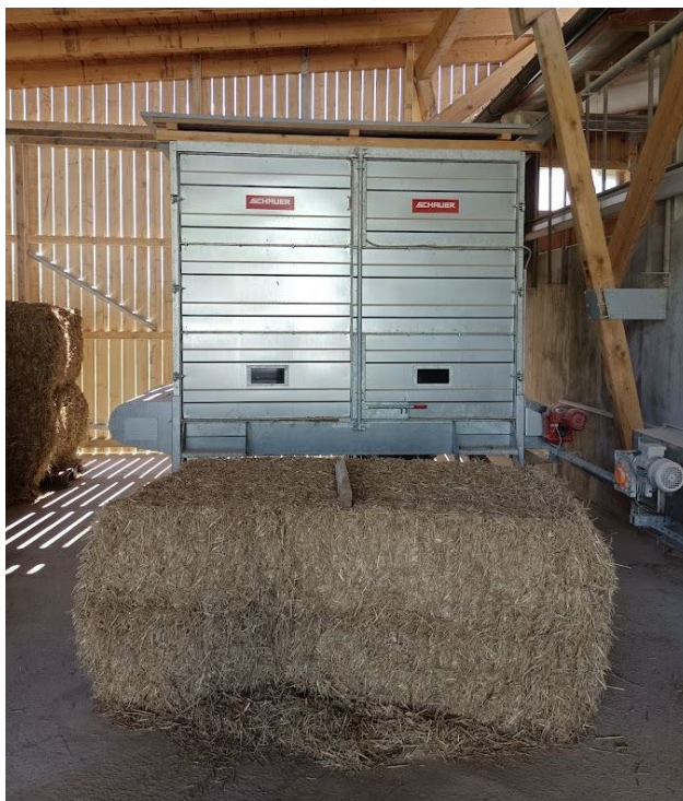
Obrázek 2.59: Systém Strohmatic pro automatickou distribuci podestýlky v podobě řezané slámy
