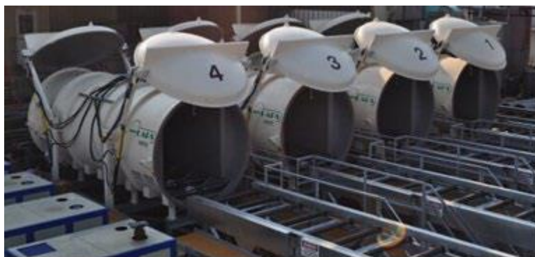
Obrázek 3.81: Systém omračování při nízkém atmosférickém tlaku
