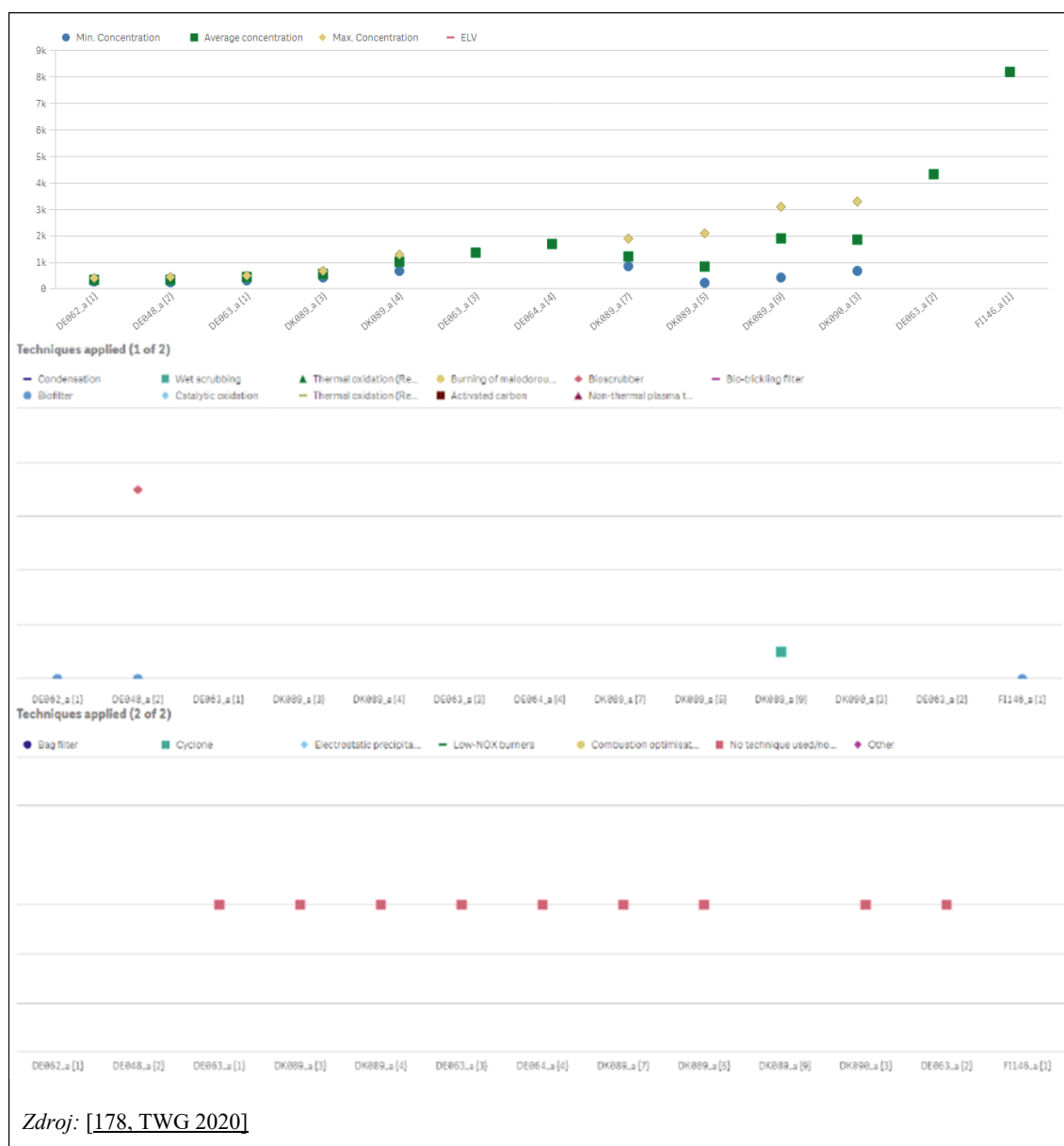
Obrázek 3.10: Emise zápachu (ou E/m^3 ) a techniky snižování emisí z jatek (část 2 ze 2)
