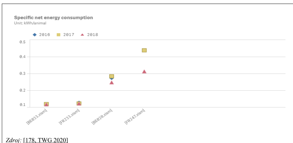
Obrázek 3.68: Specifická čistá spotřeba energie (kWh/zvíře) pro chladicí systémy na jatkách kuřat
