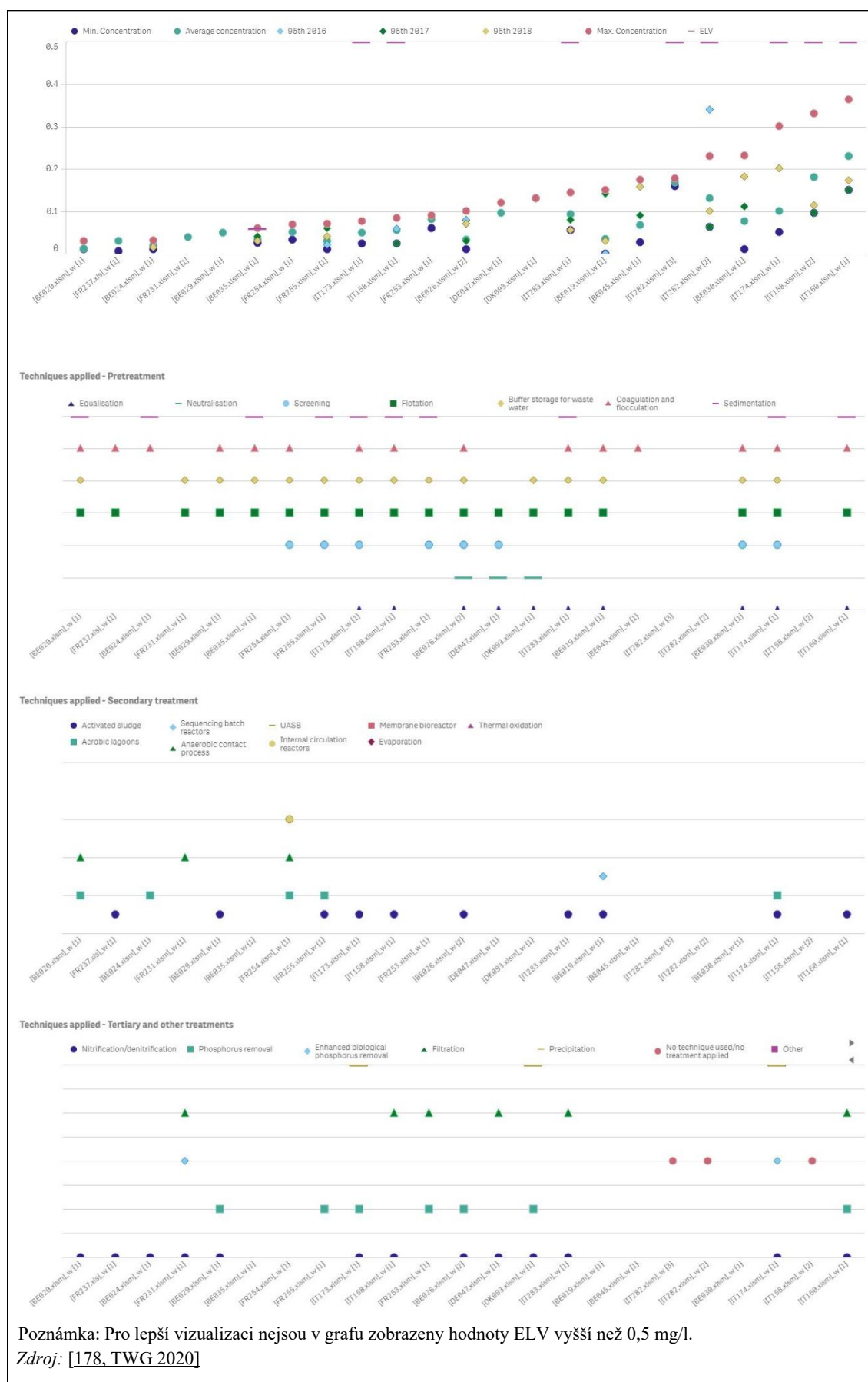
Obrázek 3.7: Emise Zn do vody (mg/l) z jatek (přímé vypouštění)
