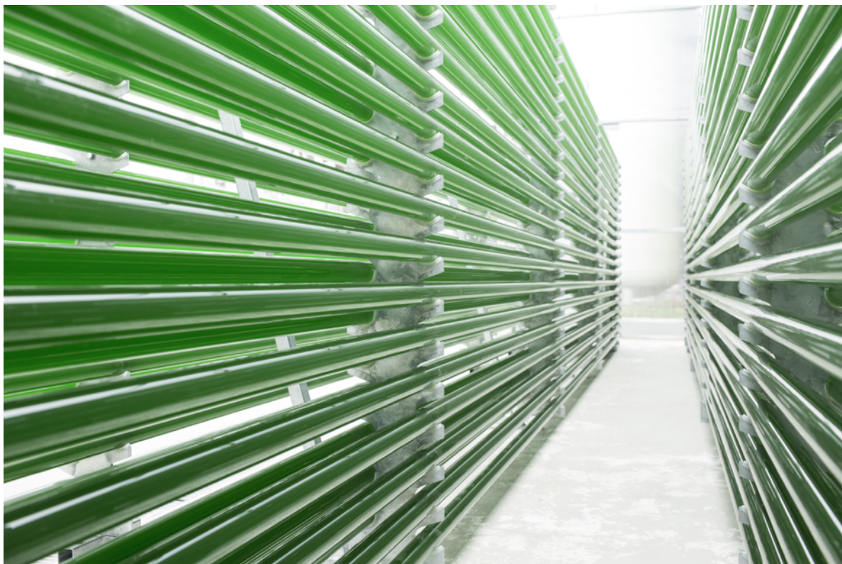
Obr. 4: Trubicový kultivační systém (Schott)
