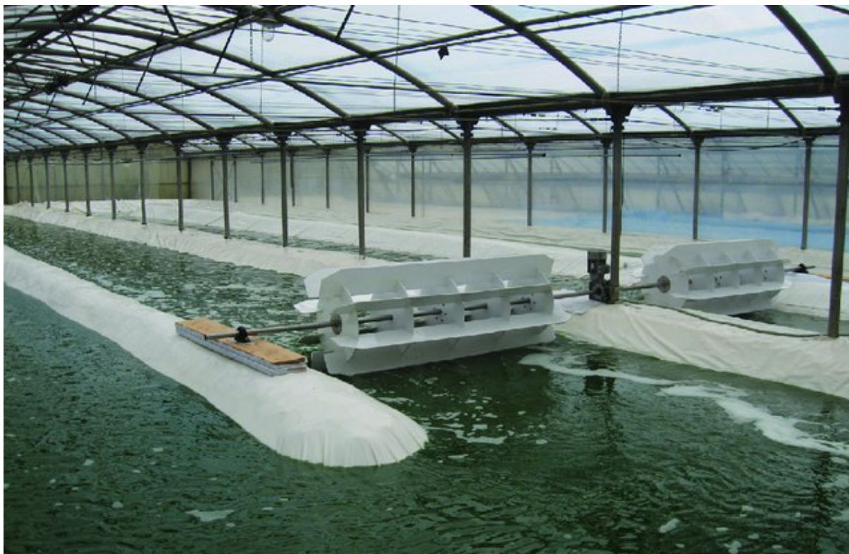
Obr. 2: Kultivační jednotka typu Oběžného náhonu (Berden-Zrimec, 2022)
