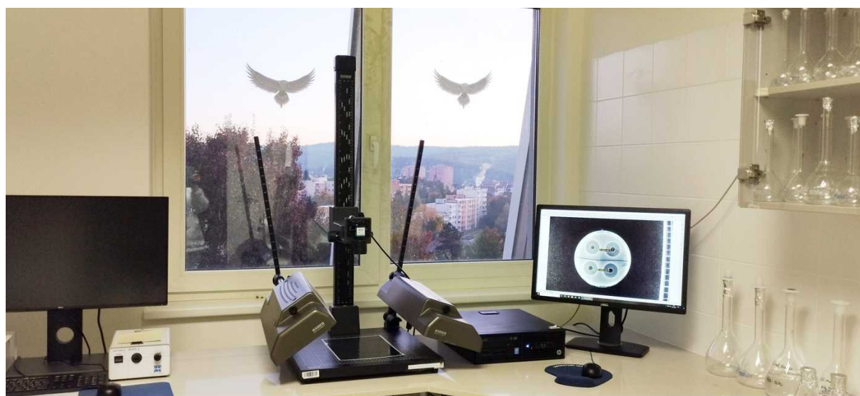
Obrázek 5. Systém snímání Petriho misek kamerou a napojení na Počítačovou analýzu obrazu (NIS – elements)
