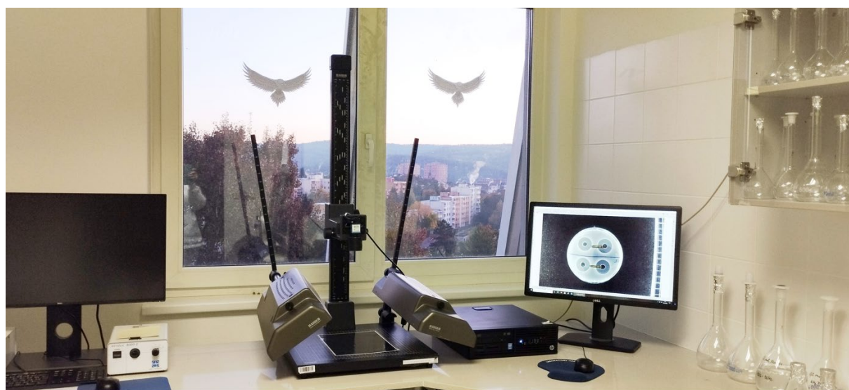
Obrázek 5. Systém snímání Petriho misek kamerou a napojení na Počítačovou analýzu obrazu (NIS – elements)
