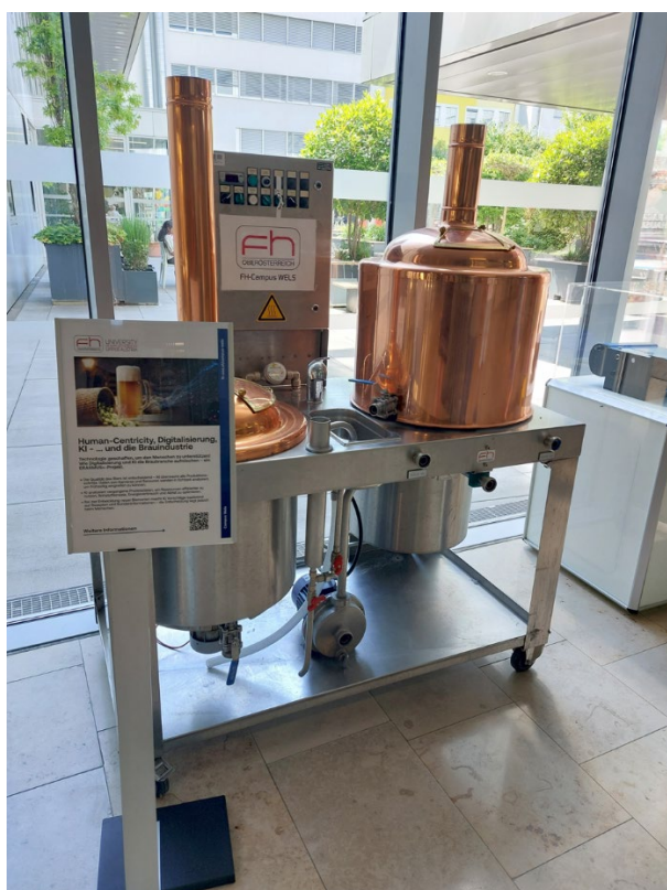
Fotografie č. 42: Experimentální minipivovar využívaný pro výuku a výzkum digitalizace a energetické optimalizace provozu.
