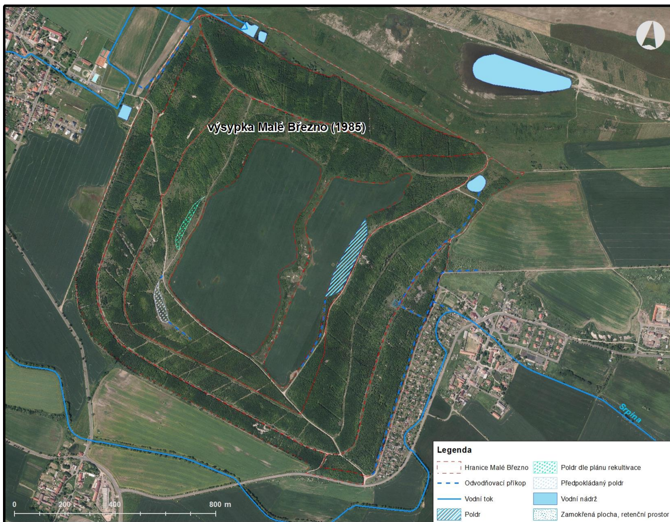
Obrázek 6: Hydrologické poměry a stávající protipovodňová a protierozní opatření na výsypce Malé Březno
