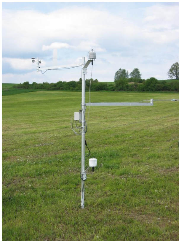
Obr. č. 13: Automatická meteostanice pro měření evapotranspirace (ETA)
