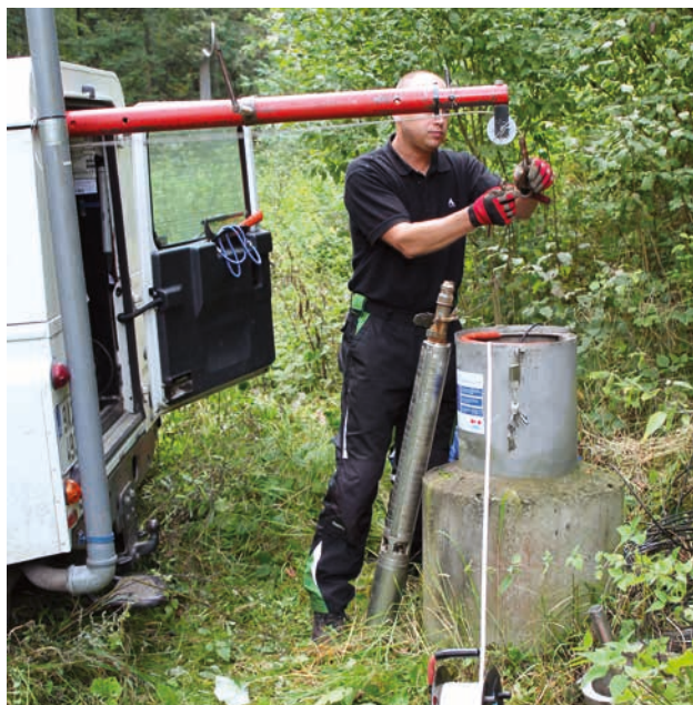
Zapouštění čerpadla do vrtu před odběrem vzorku podzemní vody (zdroj: ČHMÚ)
