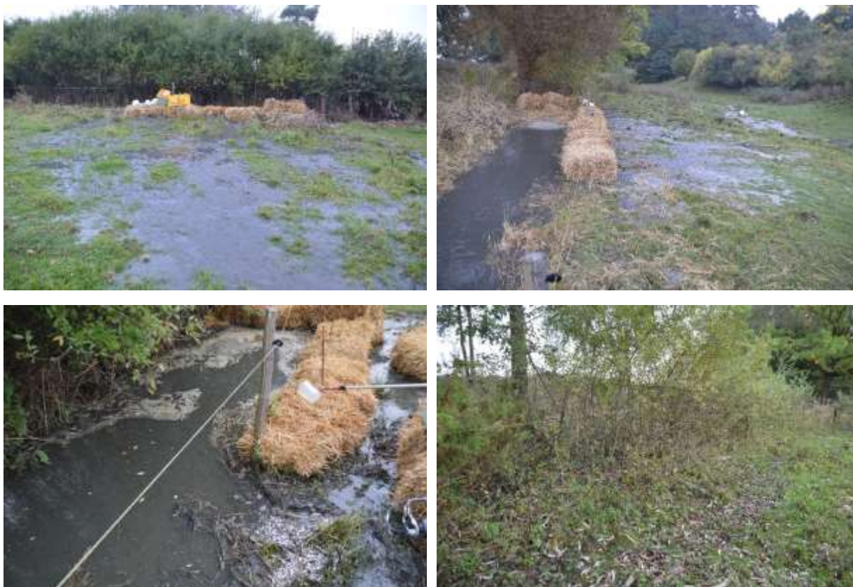
Obrázek 17. Rozlití vody na travním porostu pod první (nahore vlevo) a druhou barierou (nahore vpravo), plevelné ryby zachycené nad první barierou (vlevo dole) a zarostlá stoka nad profilem D (vpravo dole)
