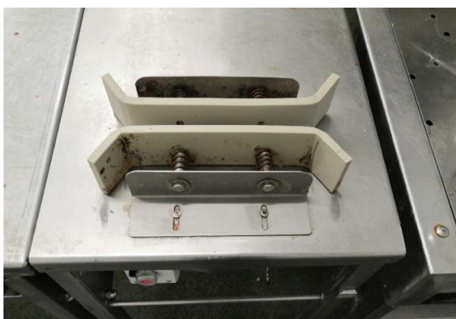
Obr. 6. Pohled na okružní pilu s vodícími lištami pro prořezávání břišní stěny ryb.
