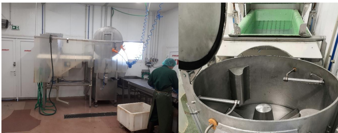
Obr. 9. Vlevo: Boční pohled na elektrickou zabíječku ryb navazující na odšupinovačku. Vpravo: Pohled shora na odšupinovačku a za ní na elektrickou zabíječku ryb s výklopným košem.
