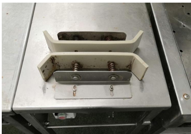
Obr. 11. Pohled na okružní pilu s vodícími lištami pro prořezávání břišní stěny ryb.
