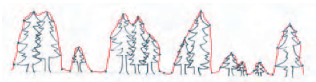
Obr. 2 Princip konstrukce normalizovaného digitálního modelu povrchu z leteckých snímků
