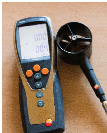
Obrázek 11 – Anemometr TESTO 445, s vrtulkovou sondou
