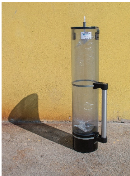
Obrázek 13 – Vakuová vzorkovací nádoba pro odběr vzduchu odsávaného ze stáje
