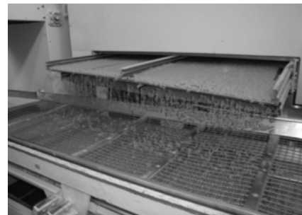
Výpad těstovin z kontinuální sušárny na krátké zboží.
