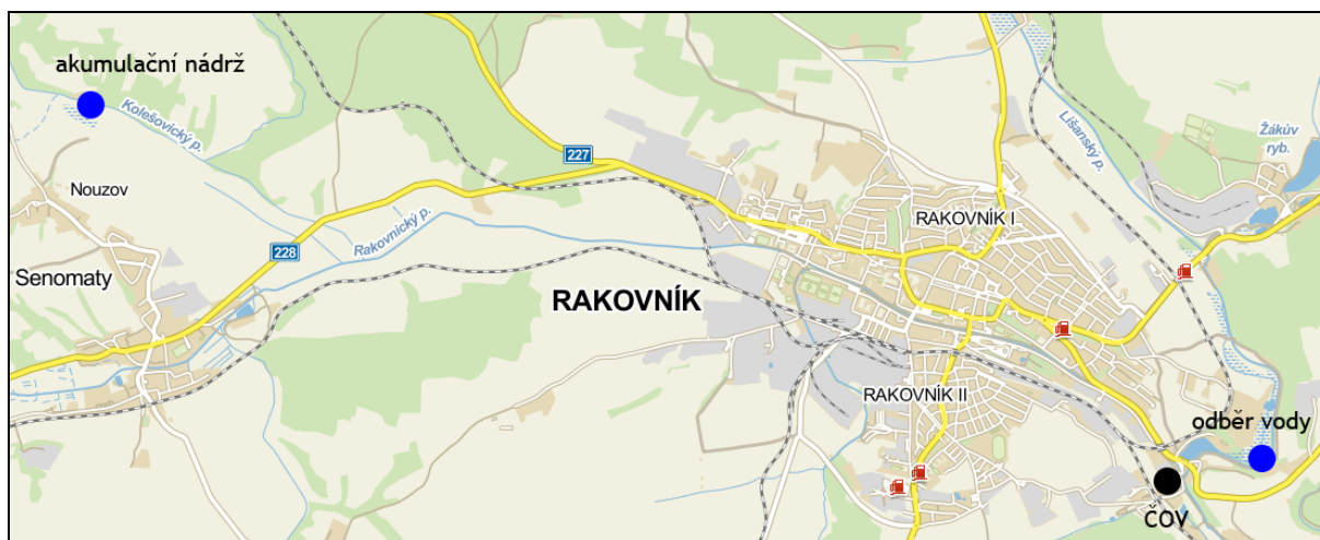
Obr. 16 Navrhované řešení recirkulace vody v povodí Rakovnického potoka umožňující příznivější hydrologickou situaci v intravilánu města Rakovník a v místě vypouštění odpadních vod (zdroj: vlastní)
