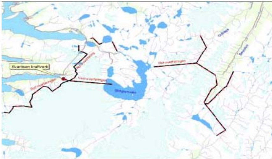
Obr.1: Voda z horní části řek Beiarelva a Grataga je odváděna do nádrže Storglomvatn z východní strany
