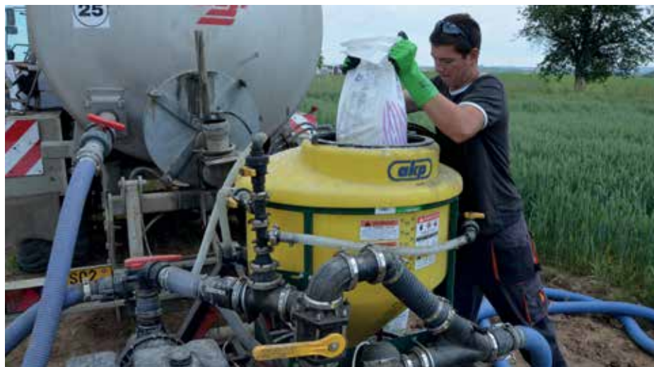
Rozmíchání přípravku – míchárna postřikové kapaliny – obsluha bez vhodných osobních ochranných prostředků
