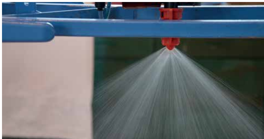
Správný výstřikový obrazec dvouštěbinové trysky
