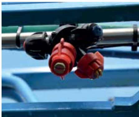
Držák trysek s protiodkapovým ventilem
