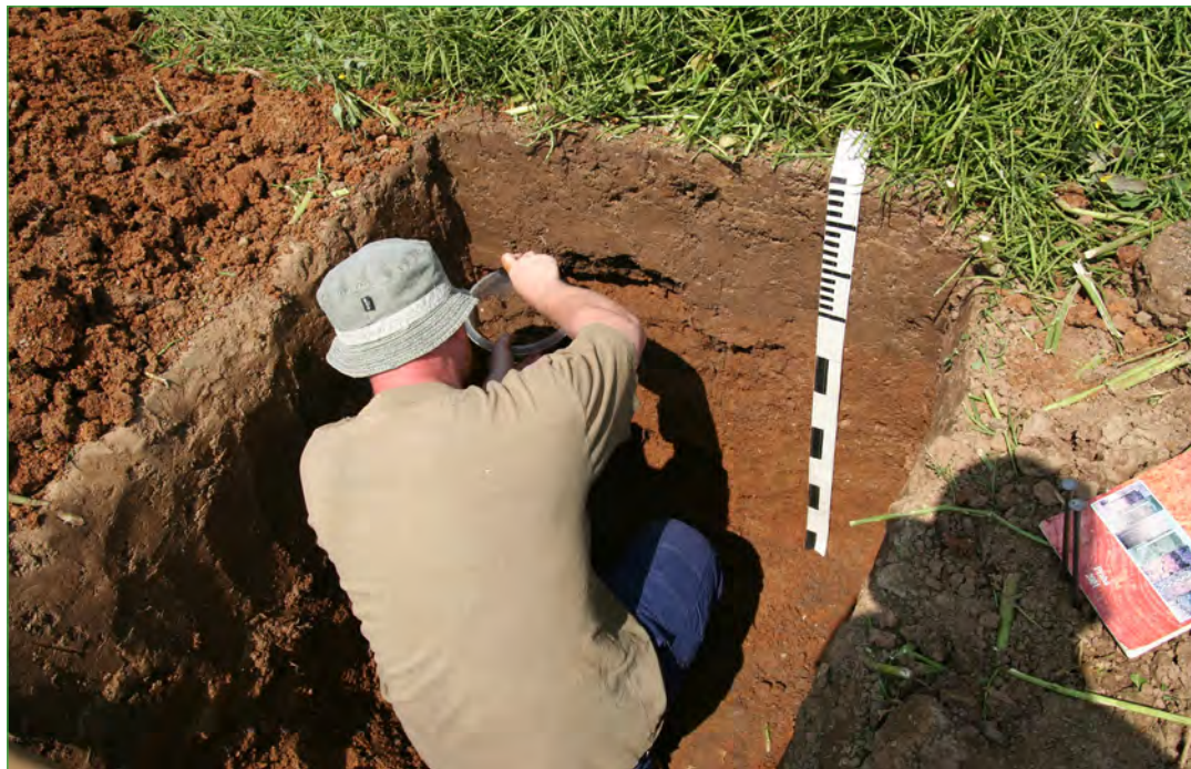
Obrázek 21. K odebrání neporušených půdních vzorků ke stanovení objemové hmotnosti redukované (OHR) a pórovitosti se používají sady Kopeckého fyzikálních válečků
