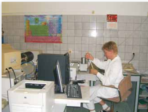
Obr. Měření stopových množství rtuti na přístroji AMA-254
