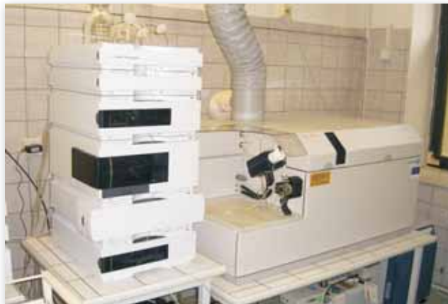
Obr. ICP-MS pro stanovení stopových množství prvků včetně jejich speciace
