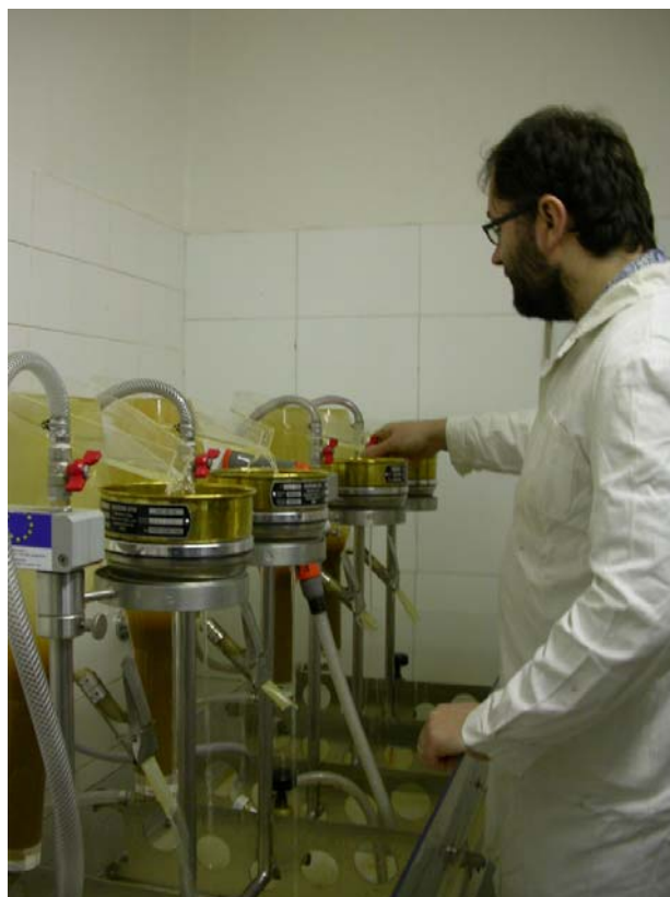
Extrakce cystotvorných nematod pomocí Thomasovy konvice v laboratoři OBO Opava (Foto: Ing. J. Olbrechtová)
