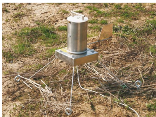
Lapač spor v blízkosti řepkové slámy pro sledování zralosti a uvolňování askospor houby Leptosphaeria spp.
