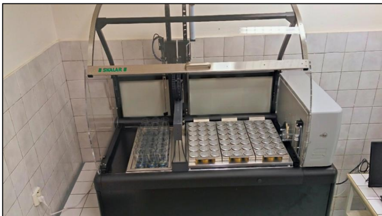
Robotický analyzátor na stanovení zrnitostního složení půdy automaticky stanovuje jednotlivé půdní frakce. Přístroj byl instalován v Brně.
