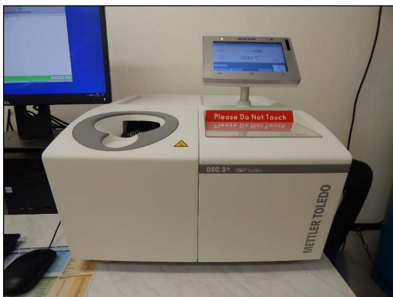
Diferenční skenovací kalorimetr DSC 3+ slouží zejména k potvrzení stejného či rozdílného chemického složení POR.
