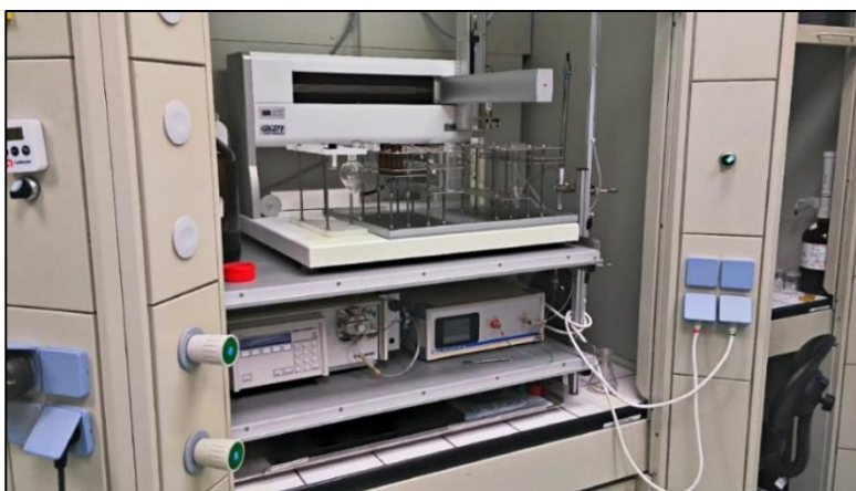
Systém pro gelovou permeační chromatografii na brněnském pracovišti umožňuje automatickou přípravu vzorků pro analýzu perzistentních kontaminantů a pesticidních látek.
